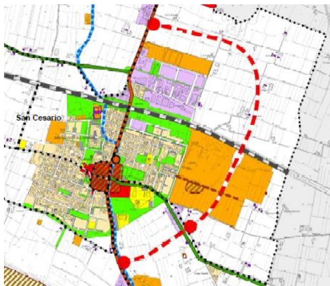
L'opera, che si connette con la viabilità esistente tramite tre rotatorie una su Via Loda, una su Via Boschetti (strada per Piumazzo) e una su Via per Spilamberto, vede la realizzazione di un cavalcavia di 50 metri a campata unica in modo da superare l'autostrada.
