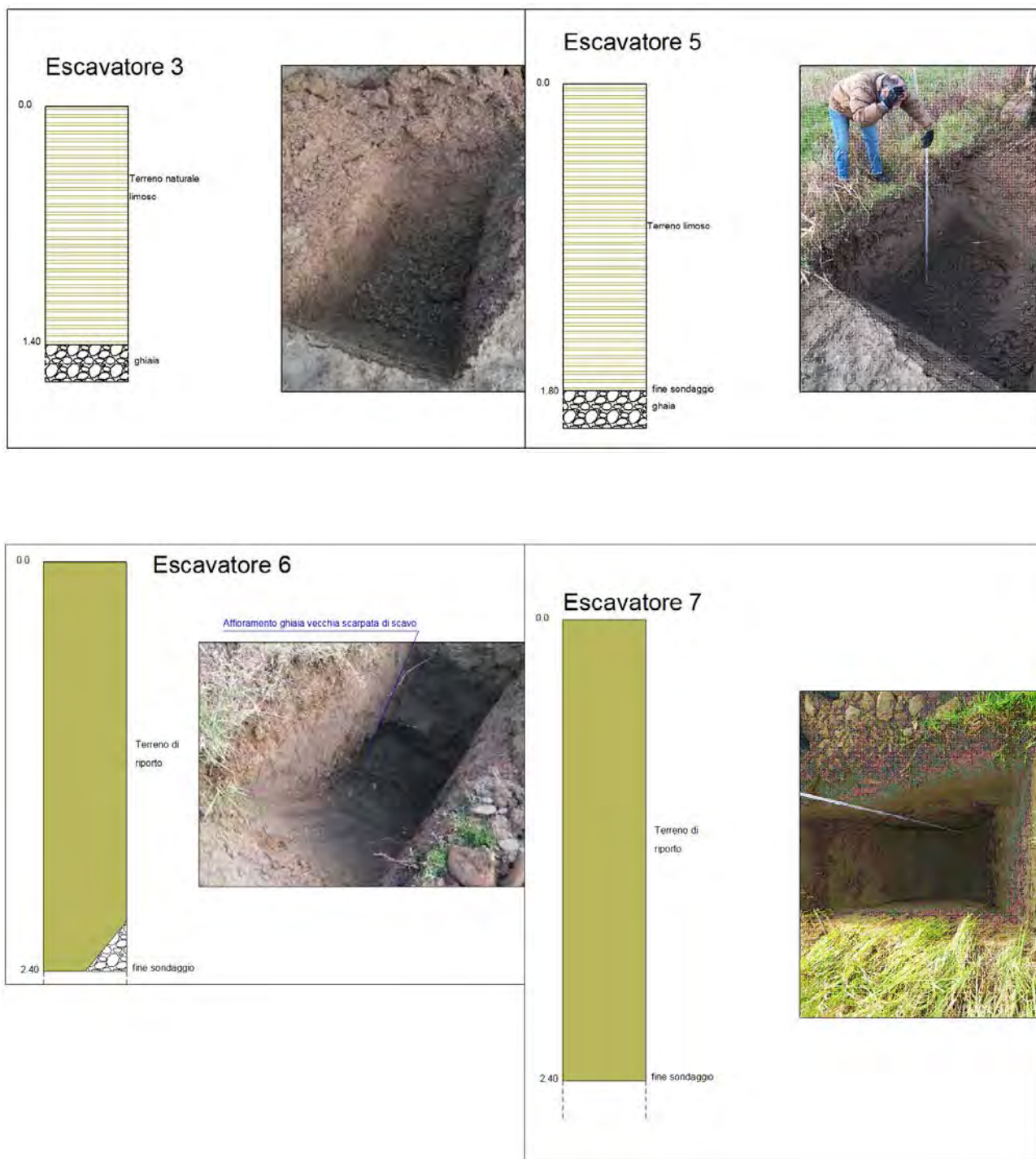
Fig. 33 - Sondaggi con escavatore meccanico del 15/12/2014
