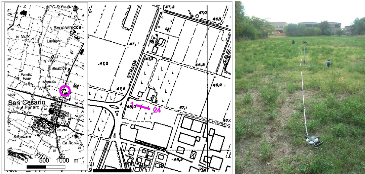
Figura 1. A sinistra: Estratto da CTR con ubicazione dello stendimento MASW (con indicazione della posizione dei geofoni 1 e 24) e inquadramento territoriale; a destra: stendimento sismico MASW di San Cesario(MO), Loc. Strada Loda, visto dall'estremità del geofono n. 1.
