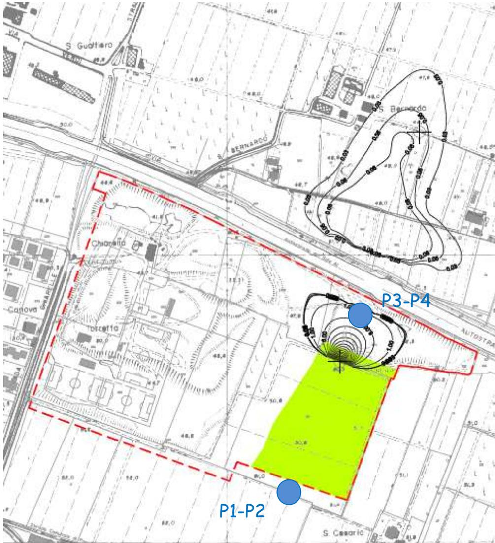
**Fig. 68** Ubicazione indicativa dei doppi piezometri di controllo - rete di monitoraggio delle acque sotterranee
