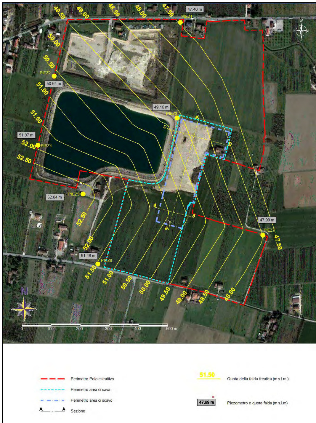
Figura 44 – Andamento piezometrico falda freatica (07/02/2014)
