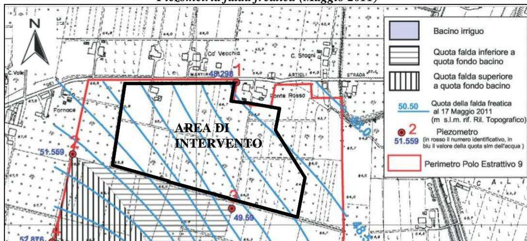
Figura 41: Livello piezometrico e di soggiacenza della falda freatica al Maggio 2011 ed ubicazione dei piezometri (fonte: “Studio Idrologico ed Idrogeologico relativo al Polo Estrattivo n° 9 “Via Graziosi””, anno 2011, dello Studio Geologico ARKIGEO, al quale fa riferimento l’Accordo 2013).
