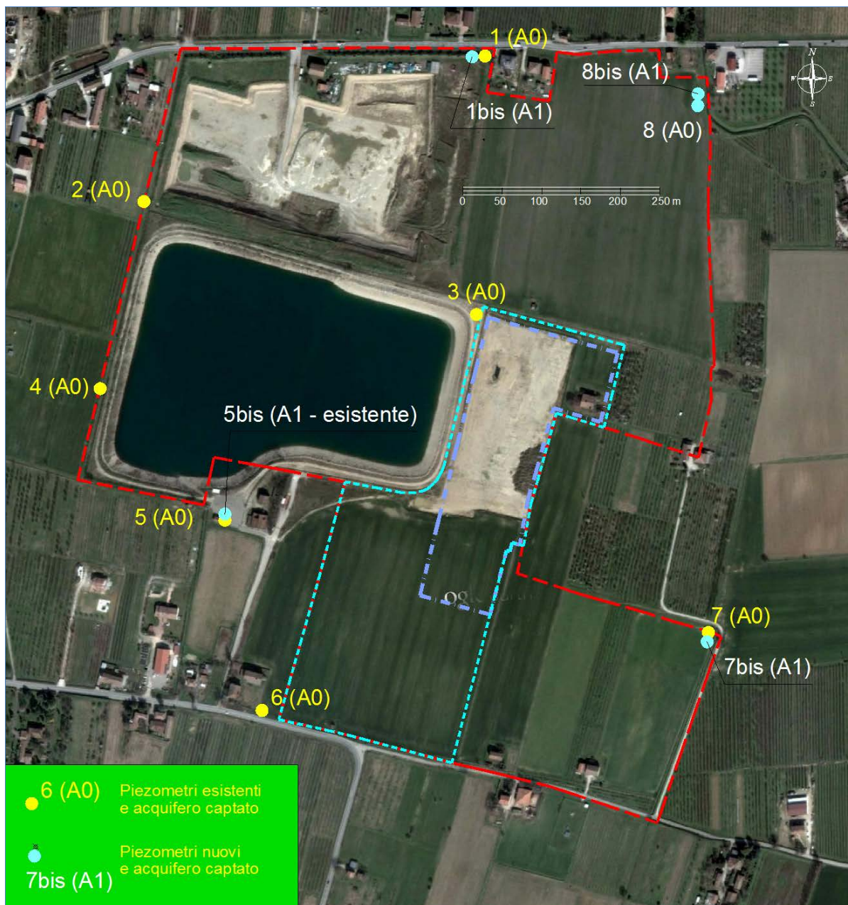
Figura 8 – Rete di monitoraggio finale acque sotterranee
